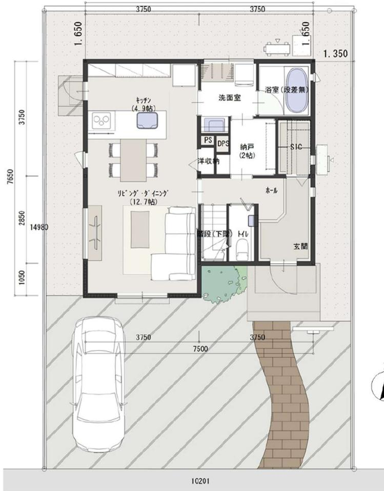
1階平面図兼配置図
